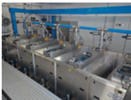
Termocondizionatore per pasta di olive per estrazioni a bassa temperatura (a sinistra) e gramole cilindriche a risparmio energetico Atmosphaera (a destra)
